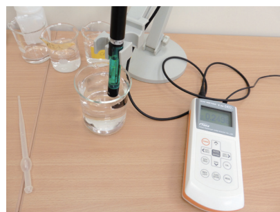
図9 塩化物イオン濃度 水質計（TOKO, TiN-5102i） Fig. 9 Chloride ion concentration, water quality meter: TOKO TiN-5102i
